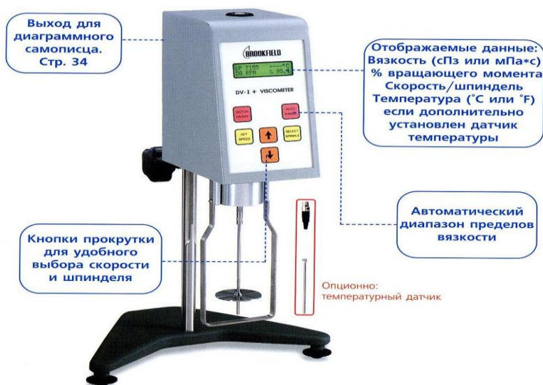
Рисунок 1 – Схема ротационного вискозиметра Brookfield
